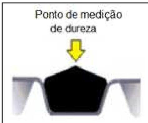
Figura 3 – Ponto para medição da dureza da gaxeta.
