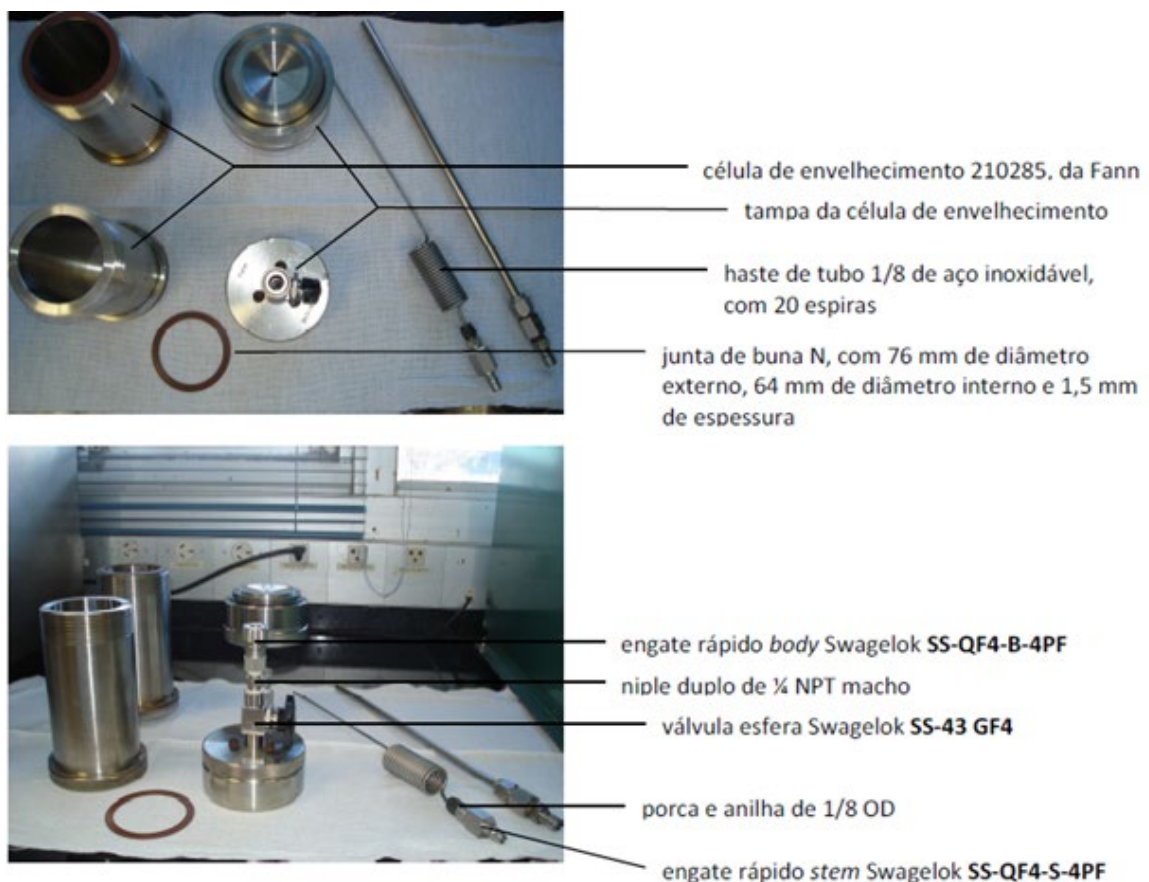
Figura 1 – Exemplo e aspecto dos materiais utilizados no conjunto para a compressão do petróleo.
