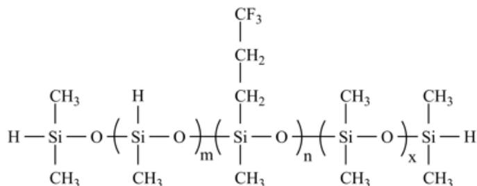
Figura 1 – Estrutura do 3,3,3-Trifluorpropil-trimetilsiloxano (matéria ativa).
