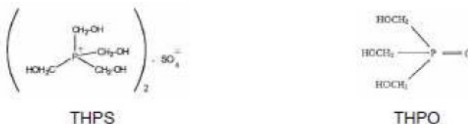
Figura 1: Estruturas químicas do THPS e THPO.
