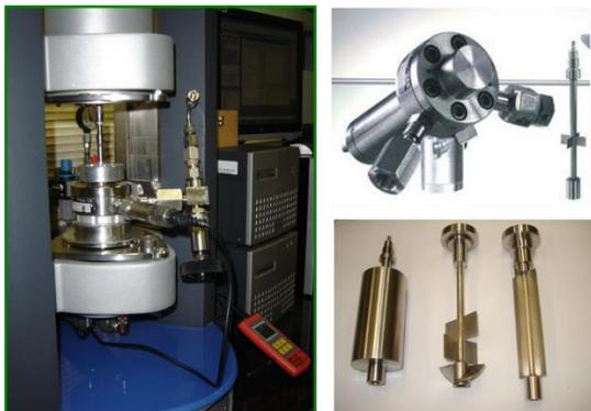
Figura 3 - Aparato experimental utilizado para qualificação do LDHI-AA. No registro fotográfico, podem ser vistos o reômetro, a célula de pressão e os sensores.
