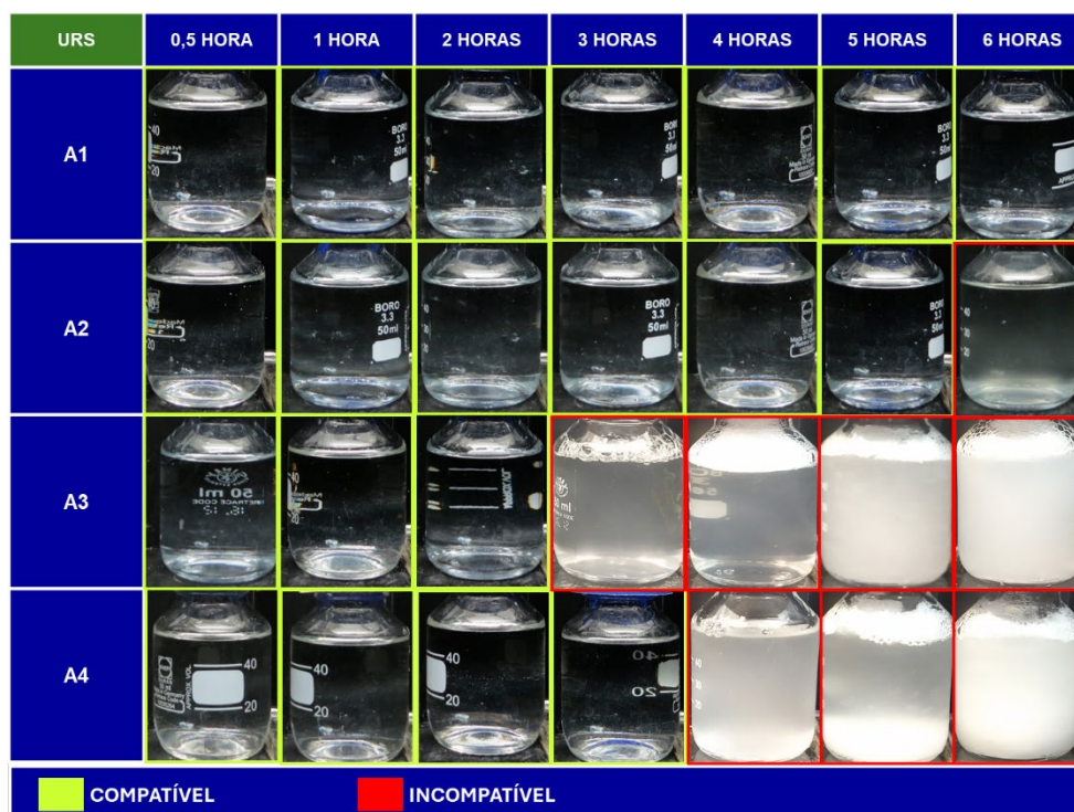
Figura 1 - Registro visual da solução em ensaio de compatibilidade estática do inibidor de incrustação [inserir nome comercial do inibidor de incrustação], na presença e na ausência do biocida [inserir o nome comercial do biocida], a 25 °C.
