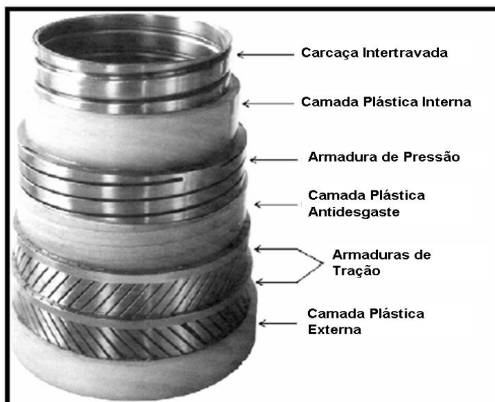
Figura 7 - Principais camadas de dutos flexíveis unbonded .
