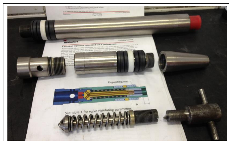
Figura 6 – Válvula de injeção de produtos químicos downhole .
