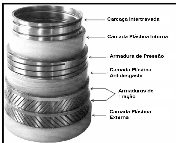
Figura 7 - Principais camadas de dutos flexíveis unbonded .
