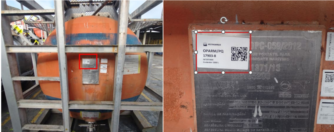
Figura 2 - Local de fixação da etiqueta com QR CODE no Tanque Offshore .
