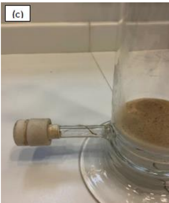
Figura 1 – Aparato experimental usado pela Petrobras para os testes de floculação avançada. (a) Coluna de flotação vazia, (b) coluna de flotação com agitador acoplado, (c) conexão para entrada de ar comprimido abaixo da placa porosa e (d) detalhe da posição do ponto de retirada de amostra do efluente tratado.
