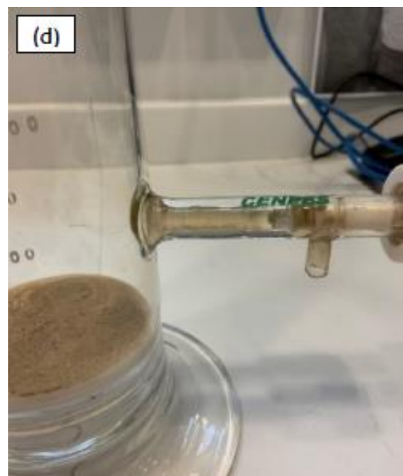
Figura 1 – Aparato experimental usado pela Petrobras para os testes de floculação avançada. (a) Coluna de flotação vazia, (b) coluna de flotação com agitador acoplado, (c) conexão para entrada de ar comprimido abaixo da placa porosa e (d) detalhe da posição do ponto de retirada de amostra do efluente tratado.
