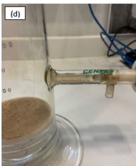
Figura 1– Aparato experimental usado pela Petrobras para os testes. (a) Coluna de flotação vazia, (b) coluna de flotação com agitador acoplado, (c) conexão para entrada de ar comprimido abaixo da placa porosa e (d) detalhe da posição do ponto de retirada de amostra do efluente tratado.
