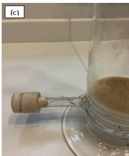
Figura 1– Aparato experimental usado pela Petrobras para os testes. (a) Coluna de flotação vazia, (b) coluna de flotação com agitador acoplado, (c) conexão para entrada de ar comprimido abaixo da placa porosa e (d) detalhe da posição do ponto de retirada de amostra do efluente tratado.
