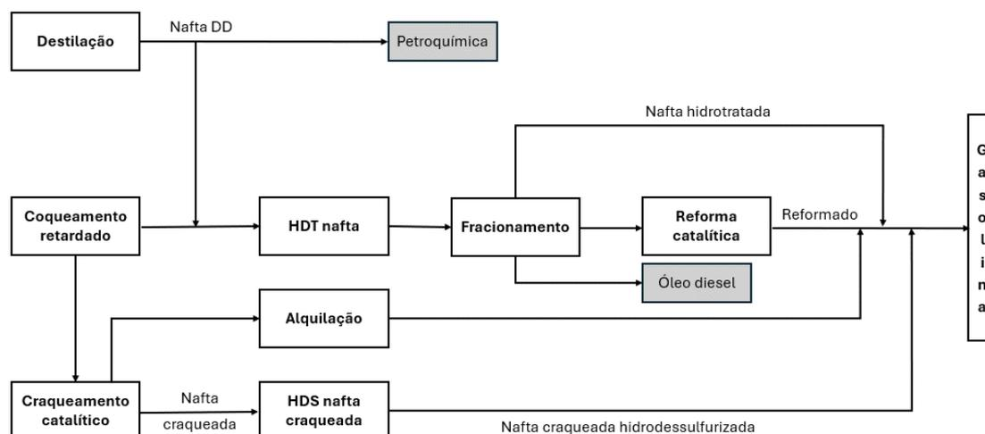
Figura 1 - Diagrama de processos de produção de gasolina (Farah, 2012)
